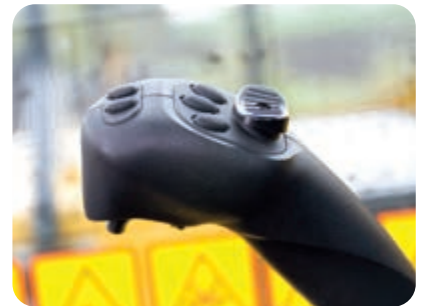
Comandi comodi, ergonomici e precisi: manipolatori con pulsante di comando proporzionale per gli accessori
