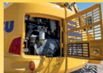
I più importanti punti di manutenzione possono facilmente essere raggiunti da terra
